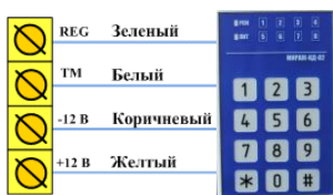
Рис. 8.4. Схема подключения кодовой панели Мираж-КД
